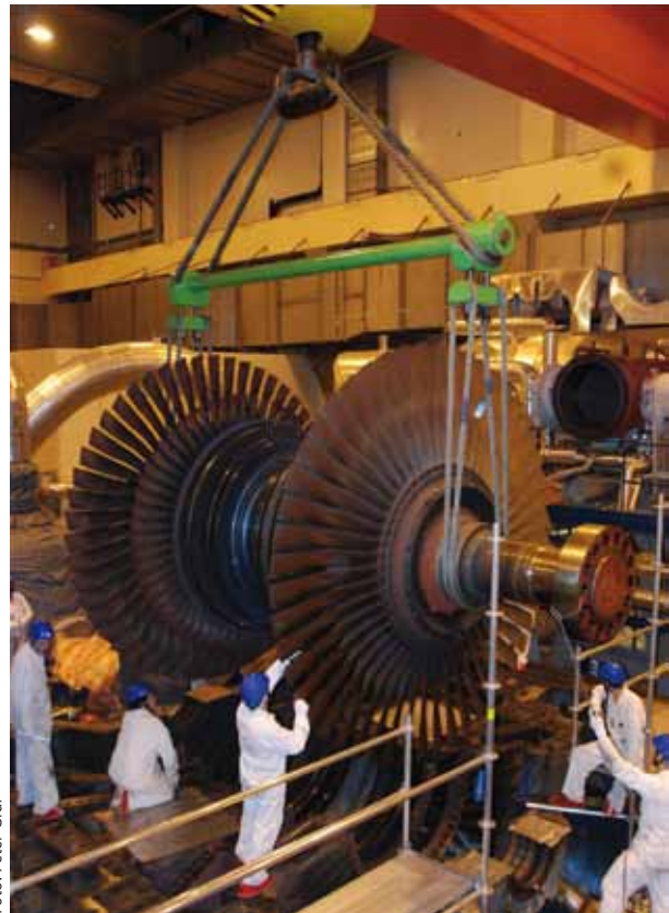
Der ausgebaut Rotor einer Niederdruckturbine zeigt deutliche Korrosionspuren vom Gebrauch.
