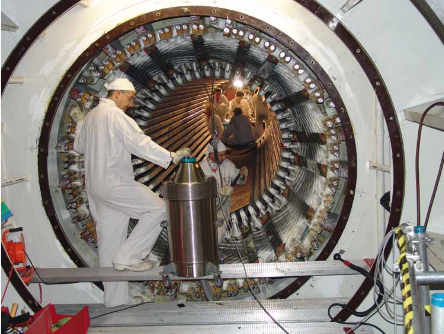
Bei ausgebautem Rotor zeigt der Blick in den Generator den Wicklungskopf mit den Anschlüssen für die Wasserkühlung.
